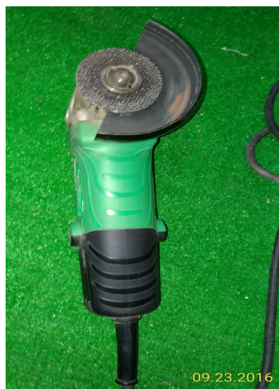
說明：已設置護罩改善
