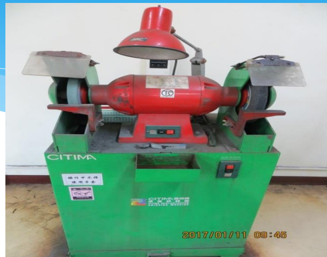
研磨機-磨輪設護罩
